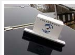
Reinigungsroboter putzt Solarzellen in der Wüste
